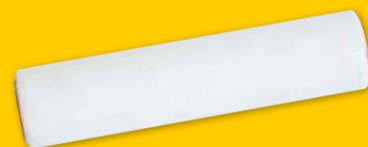
Hochwertiger Farbroller aus Mikrofaser-Garnen und einer Polyester Mischung mit einer Schurhöhe von 5 mm. Der Kurzhaarroller eignet sich zum Auftragen von Acryl- und Alkydharzlacken, PU-Lacken und Ölen. Der Verlauf der Farbe ist optimal und es entsteht eine fusselfreie, glatte Oberfläche ohne Streifen. Erhältlich in 10 und 25 cm.
